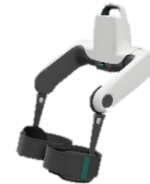
Hip exoskeleton (Össur)
