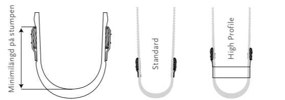
På Iceross Seal-In V HP sitter tätningsringen placerad ca 30 mm högre upp än på standardlinern
