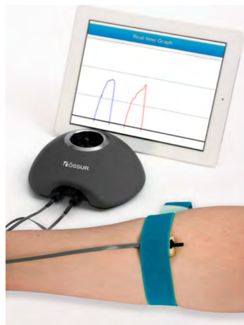
Virtu-Limb för att mäta myo-elektriska signaler
