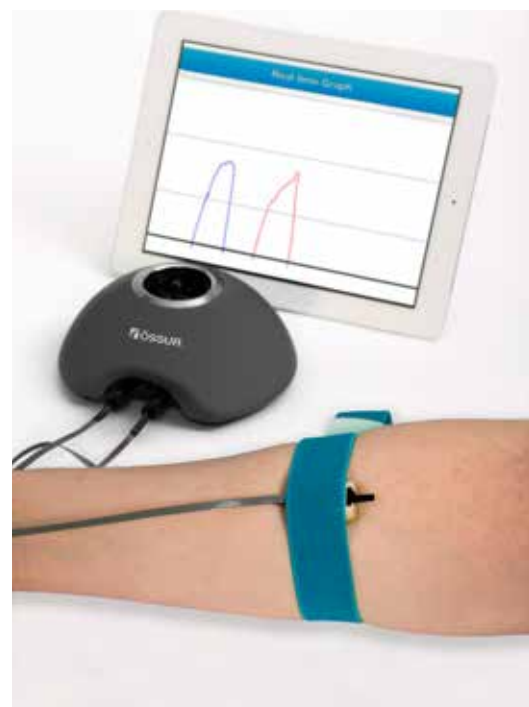
Virtu-Limb™ voor het meten van myo-elektrische signalen
