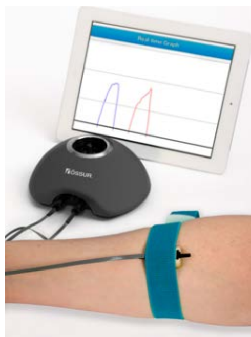
Virtu-Limb för att mäta myo-elektriska signaler
